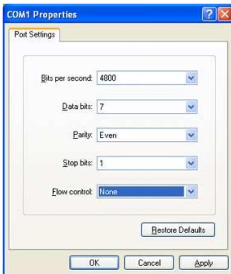
**Рисунок 11** Настройки последовательного порта при помощи программы HyperTerminal
