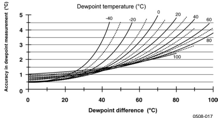
Рисунок 16 Погрешность измерения точки росы
