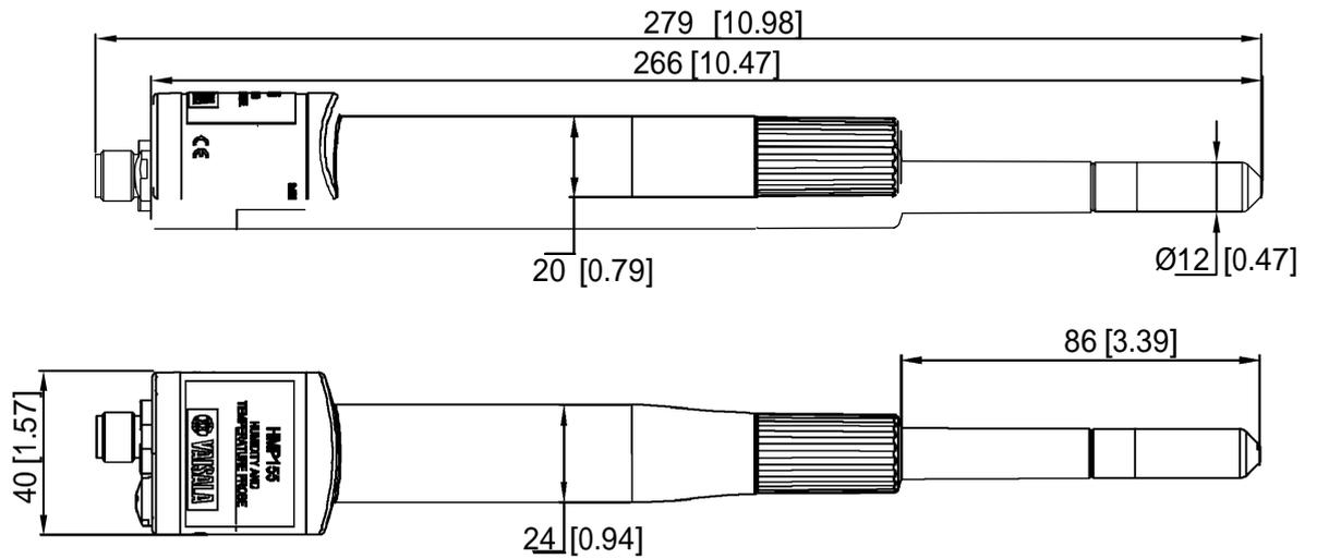
Рисунок 17 Размеры датчика
