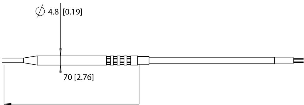
Рисунок 18 Размеры опционального датчика температуры
